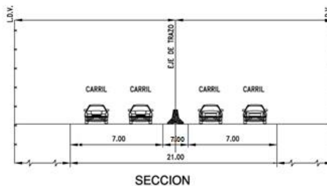
Figura 7 Carretera Costera - Sección Tipo
