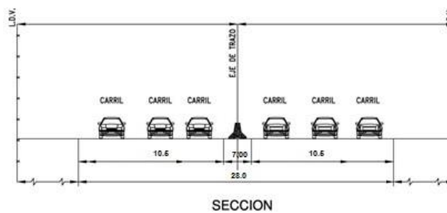
Figura 14 Sección tipo del proyecto
